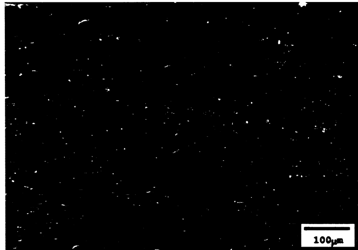
Figura 4.37. Micrografía de la superficie de fractura en la zona lisa del PP-R1. El PP-R6 también presenta una zona homóloga a ésta.
