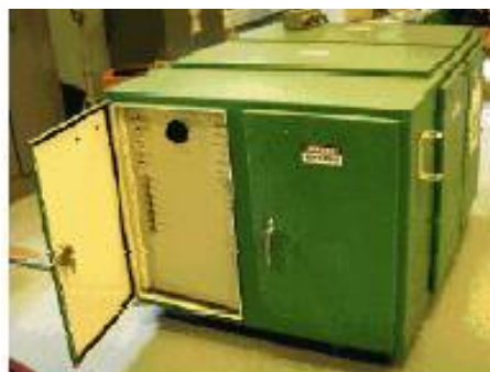
Figura 5.3: Fotografía del banco de capacitores de 16kj utilizado para los experimentos básicos situado en la universidad de The Ohio State University
