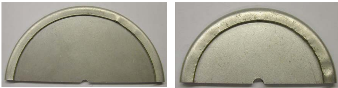
Figura 6.74: Piezas engatilladas de 7mm de altura de pestaña con distintos diámetros exteriores de 90mm (izquierda) y 60mm (derecha).
