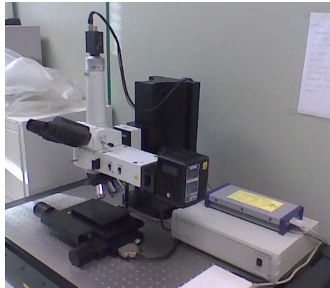
Figura 4.9: Perfilómetro confocal para realizar las mediciones del combado situado en MU.
