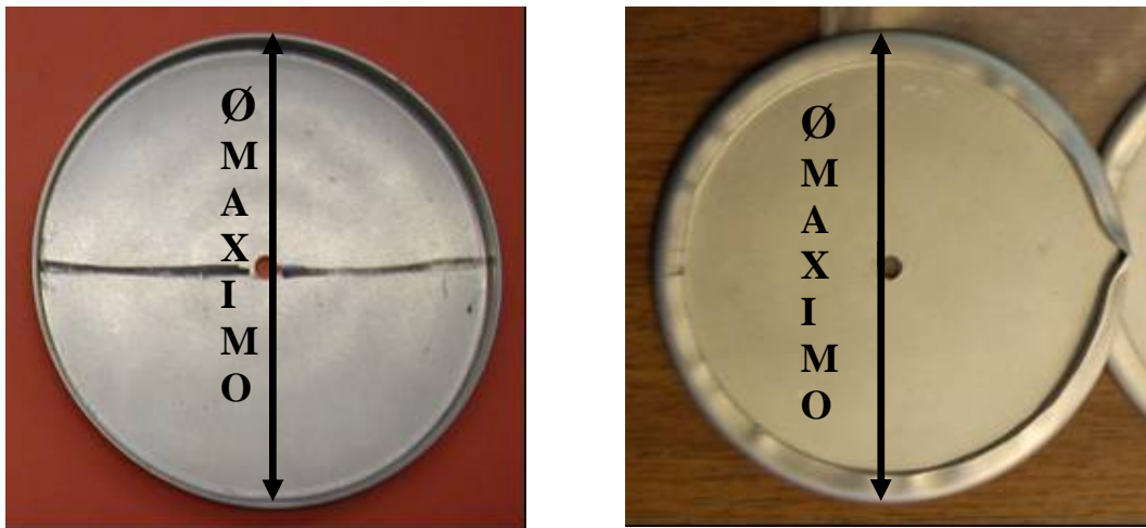
Figura 6.68: Zona de medición del diámetro máximo antes de engatillar (izquierda) y después de engatillar (derecha) para calcular el enrollamiento.
