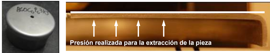
Figura 6.21: Pieza doblada al 60% de solapamiento sujeta al mandrino (izquierda) y deflexión de la superficie apreciable a simple vista generada al extraer la pieza (derecha).
