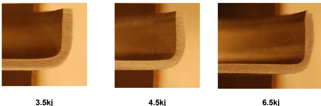
Figura 6.25: Piezas dobladas por EMF a distintas energías lo que produce distintos grados de reducción de espesor y de combado.
