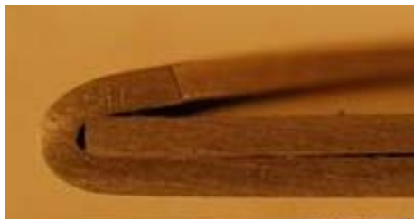
Ø90mm, 30% de solapamiento, zona deformada=1,9mm
