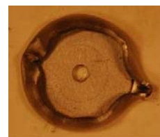
Figura 6.81: Generación de arrugas al engatillar una zona convexa (izquierda) [LIV04b] y arrugas excesivas generadas al intentar engatillar una pestaña de 7mm de altura para el diámetro exterior de 30mm (derecha).
