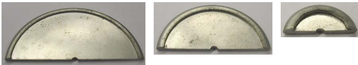
Figura 6.73: Piezas engatilladas de 5mm de altura de pestaña con distintos diámetros exteriores de 90mm (izquierda), 60mm (centro) y 30mm (derecha).
