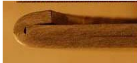
Ø60mm, 40% de solapamiento, zona deformada=2,1mm
