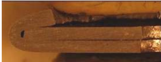
Ø30mm, 50% de solapamiento, zona deformada=2,36mm
