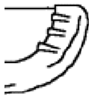
Figura 6.81: Generación de arrugas al engatillar una zona convexa (izquierda) [LIV04b] y arrugas excesivas generadas al intentar engatillar una pestaña de 7mm de altura para el diámetro exterior de 30mm (derecha).
