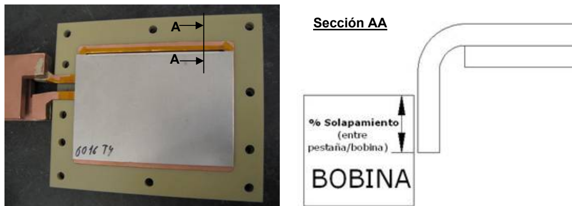
Figura 5.4: Bobina de engatillado recto con la pieza en posición (izquierda) y plano de la sección AA explicando el parámetro del solapamiento (derecha).
