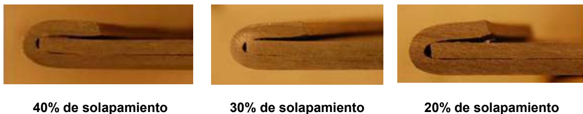
Figura 6.43: Geometrías modelo analizadas para establecer la geometría modelo óptima en el caso del \varnothing 90\text{mm} .
