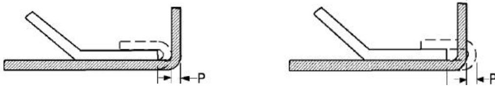
Figura 4.11: Enrollamiento negativo (roll-in) (izquierda) y enrollamiento positivo (roll-out) (derecha) [LIV04b].
