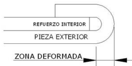
Figura 4.12: Zona deformada de una unión engatillada
