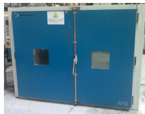
Figura 2.2. Estufa AFA 200/3000 empleada en el curado convencional de los materiales compuestos furánicos.
