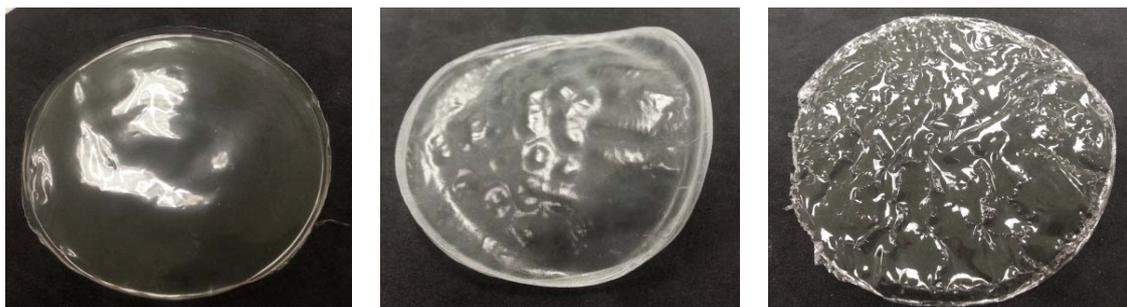
**Figura 74** Comparativa de varios films tras haber sido expuestos a diferentes tipos de evaporación. Izqda.: film liso con evaporación a temperatura ambiente. Centro: evaporación a 40 °C. Dcha.: evaporación a 50 °C.
