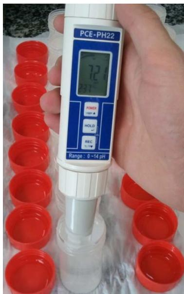
**Figura 73** Medición de los valores de pH con la ayuda de un pH-metro digital durante el cambio de líquido fisiológico.
