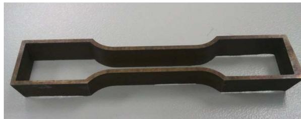
**Figura 62** Punzón metálico con la forma interna de la probeta (probeta hembra).
