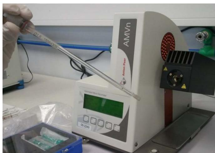
**Figura 70** Micro-viscosímetro de caída de bola.
