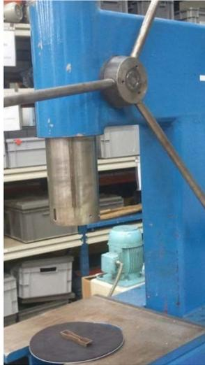
**Figura 63** Dispositivo utilizado para la obtención de las muestras: prensa manual.
