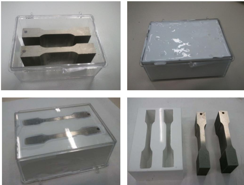
**Figura 64** Proceso de fabricación de los moldes de silicona. Arriba izqda.: machos metálicos en la caja. Arriba dcha.: caja rellena de silicona. Abajo izqda.: conjunto visto desde la parte inferior. Abajo dcha.: molde de silicona y probetas metálicas.
