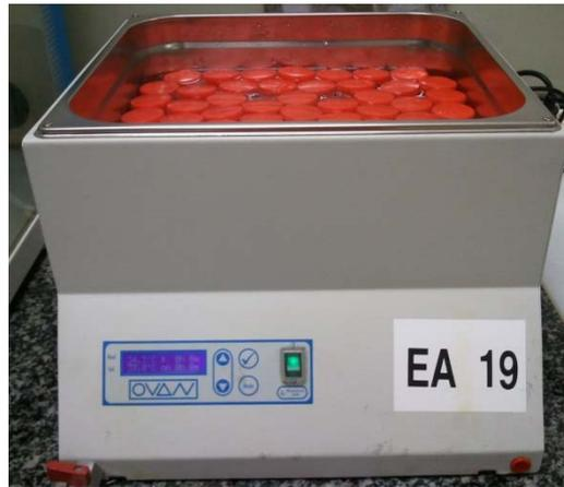
**Figura 72** Configuración del baño de agua a 37 °C con los botes en su interior durante el experimento de biodegradación.
