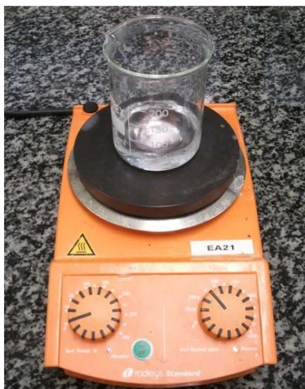
**Figura 43** Agitador magnético utilizado para remover la disolución.
