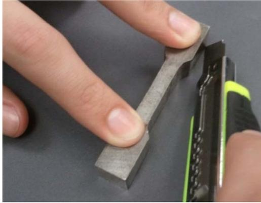
**Figura 61** Obtención manual de las probetas de tracción mediante una cuchilla.
