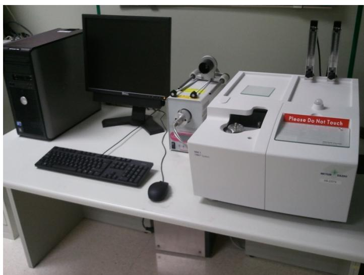
**Figura 47** Imagen de foto-calorímetro diferencial de barrido (DSC).
