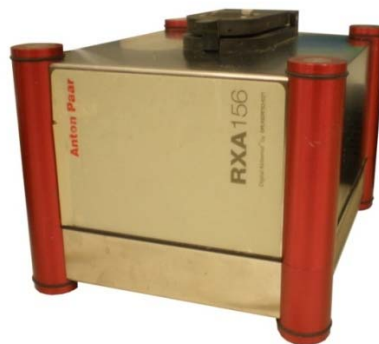
Figura 3. 8. Refractómetro Anton Paar RXA 156 de la universidad de Mondragón.
