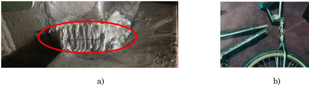
Figura 1.3. a) Fisura generada por fatiga en el alojamiento de un eje en una prensa mecánica y b) fallo generado en la unión soldada de tubos finos en una bicicleta [9].
