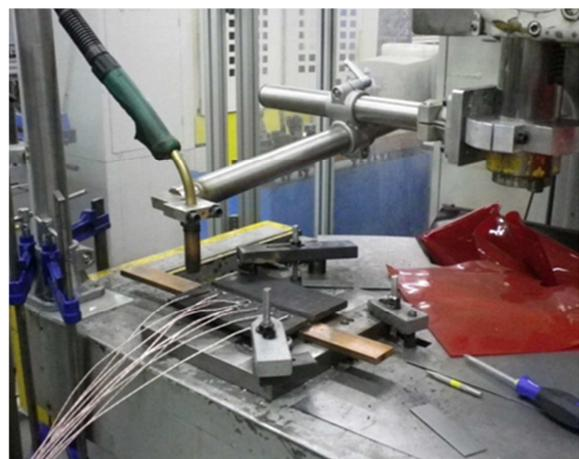
**Figura 2.26.** Instalación experimental desarrollada para realizar el ensayo de soldadura controlado.
