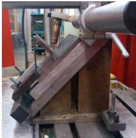
**Figura 2.41. Instalación experimental desarrollada para el ensayo de soldadura en T.**
