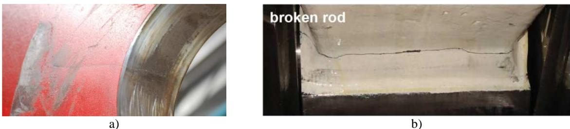
**Figura 1.2. Fisuras generadas por fatiga en componentes de prensas mecánicas: a) unión soldada y b) biela.**
