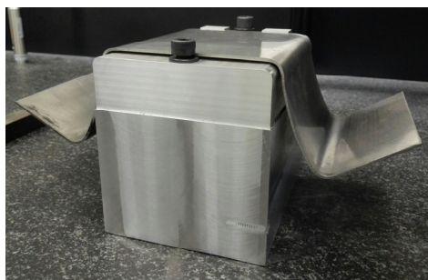
Fig 5-3: Maqueta para medición de especímenes y Probeta de U - Drawing
