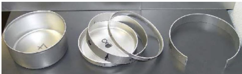
Fig 2-46: De izquierda a derecha, copa embutida, anillos y springback después del corte de un anillo (Laurent et al. 2010)
