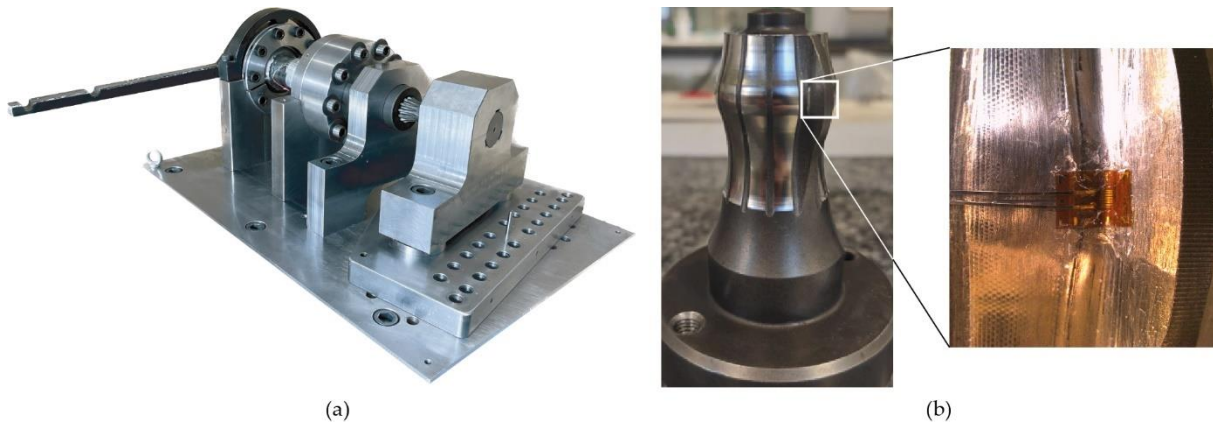
Figura 3: (a) banco de ensayos diseñado [4] para realizar los ensayos experimentales, y (b) eje del acoplamiento mecanizado y galga extensiométrica utilizada para medir las deformaciones de flexión.
