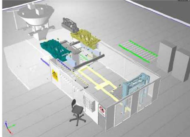
FIGURA 2.2: Emulación de máquina de machos como soporte al proyecto de su reacondicionado.
