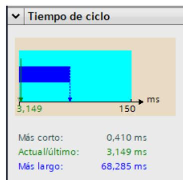
FIGURA 6.16: Medición del período de ejecución en TIA Portal.
