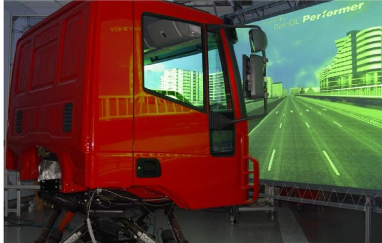
FIGURA 7.1: Simulador de camión.
