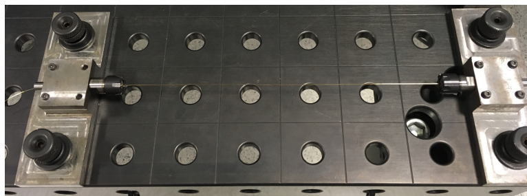
Figura 4.23: Útil de montaje del hilo para la definición de la longitud de la probeta.
