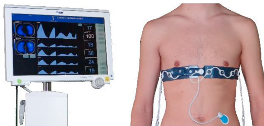
Figure 2. Sketch of the EIT device and the EIT electrode belt in height of ICS5.
