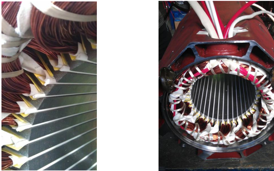
Figura 5-5 Detalle de las ranuras (izquierda) y estator y carcasa (derecha)
