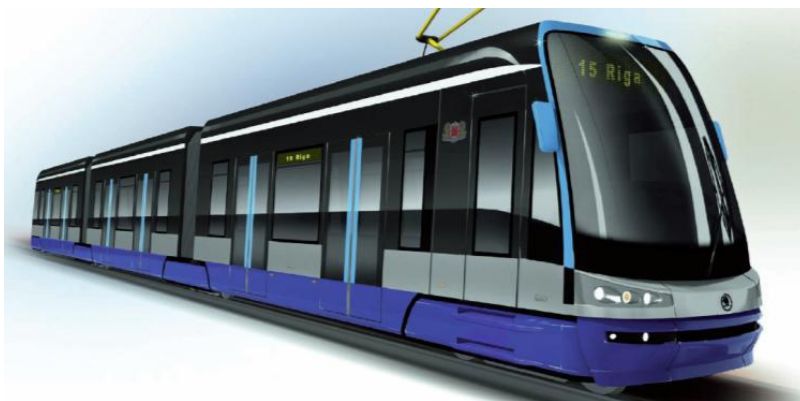
Figura 1-5 Tranvía de Riga con accionamiento directo de SKODA ELECTRIC a.s.
