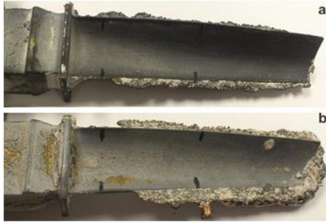
Figura 4-16. Dos de los álabes obtenidos por fundición: a) molde a 25°C, b) molde a 500°C.
