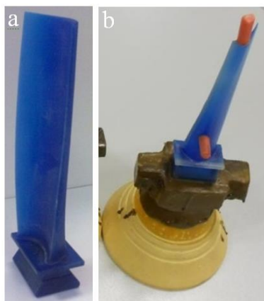
Figura 4-14. a) Patrón calcinable obtenido mediante impresión 3D, b) Conjunto de cera final
