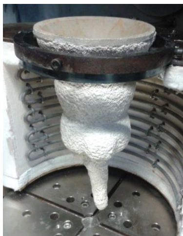
Figura 4-15. Cáscara cerámica obtenida tras el quemado.
