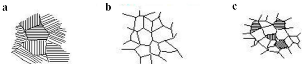
Figura 2-4. Tipos de microestructura: a) Laminar, b) Equiaxial, c) Dúplex (ASM 2005)
