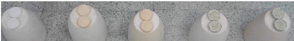
Figura 5-20. Muestras cerámicas obtenidas tras el quemado: ZSO, ZSO-15TP, ZSO-40TP, ZSO-15TV y ZSO-40TV
