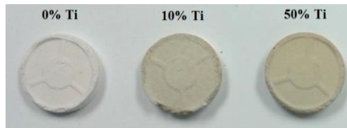
Figura 5-13. Pastillas cerámicas obtenidas después del quemado
