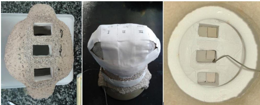
Figura 5-14. Molde cerámico adaptado para albergar muestras de las distintas pastillas cerámicas
