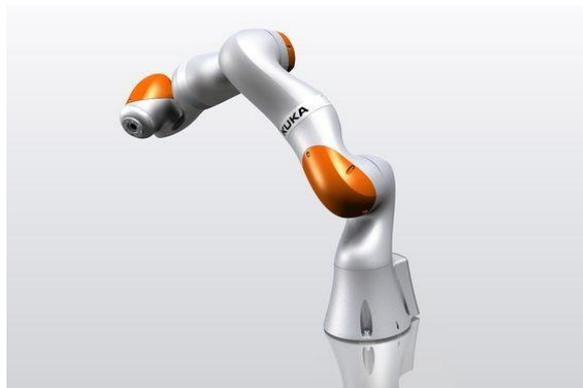
Figura 40: Robot utilizado en los casos de estudio: KUKA IIWA 14 R820 (*LBR iiwa | KUKA AG, s. f.*).
