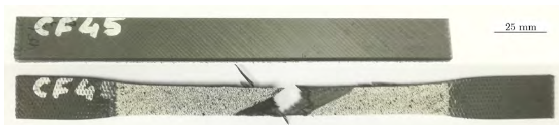
Figura 4.9 Comportamiento a cizalladura intralaminar. Aspecto de la probeta antes y después del ensayo.
