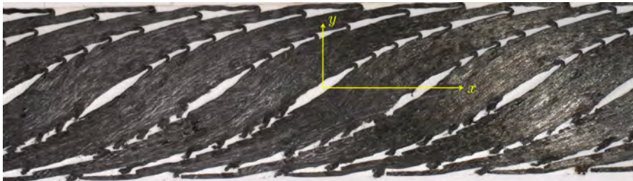
Figura 5.4 Configuración \langle 45|10 \rangle obtenida mediante el desplazamiento axial de la superficie de control, impresa sobre una capa de Nylon blanco y sin relleno de Onyx para una mejor visualización.
