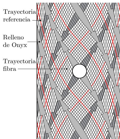
Figura 7.13 Modelización según-fabricación: vacíos rellenos de Onyx y trayectoria de la fibra de las dos capas adyacentes \pm(45|10) de fibra-dirigida.
