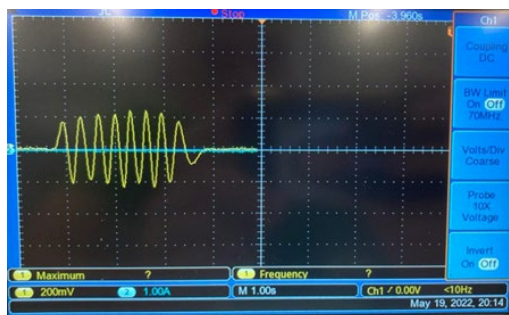
Figura 10 – Test de pares de polos del PMSG
