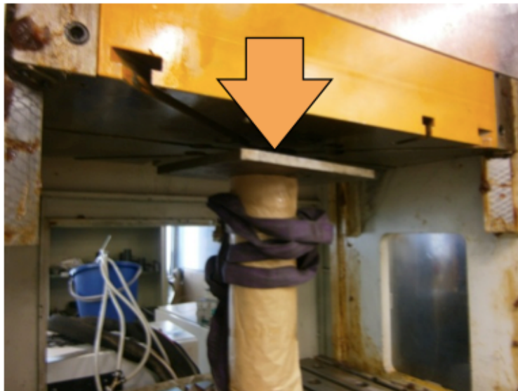
1. Apriete del tubo interior con la tapa mediante una prensa
