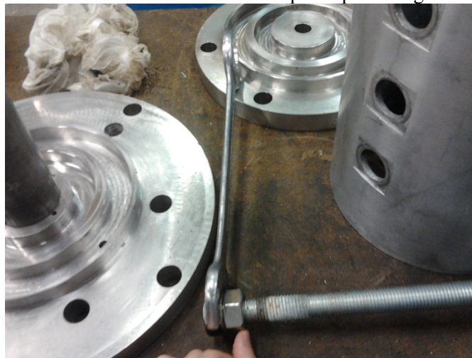
Llave fija que impide el giro de la barra cuando se deslice la tuerca sobre la barra
