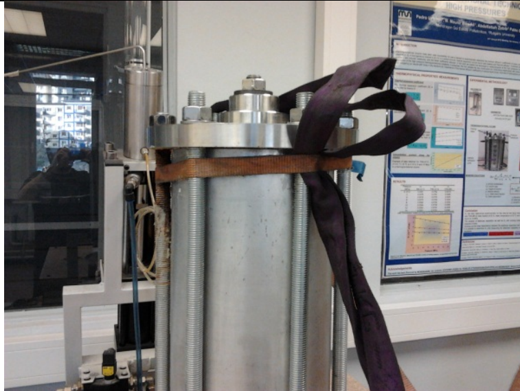
Amarre de la columna mediante una cincha y eslingas
