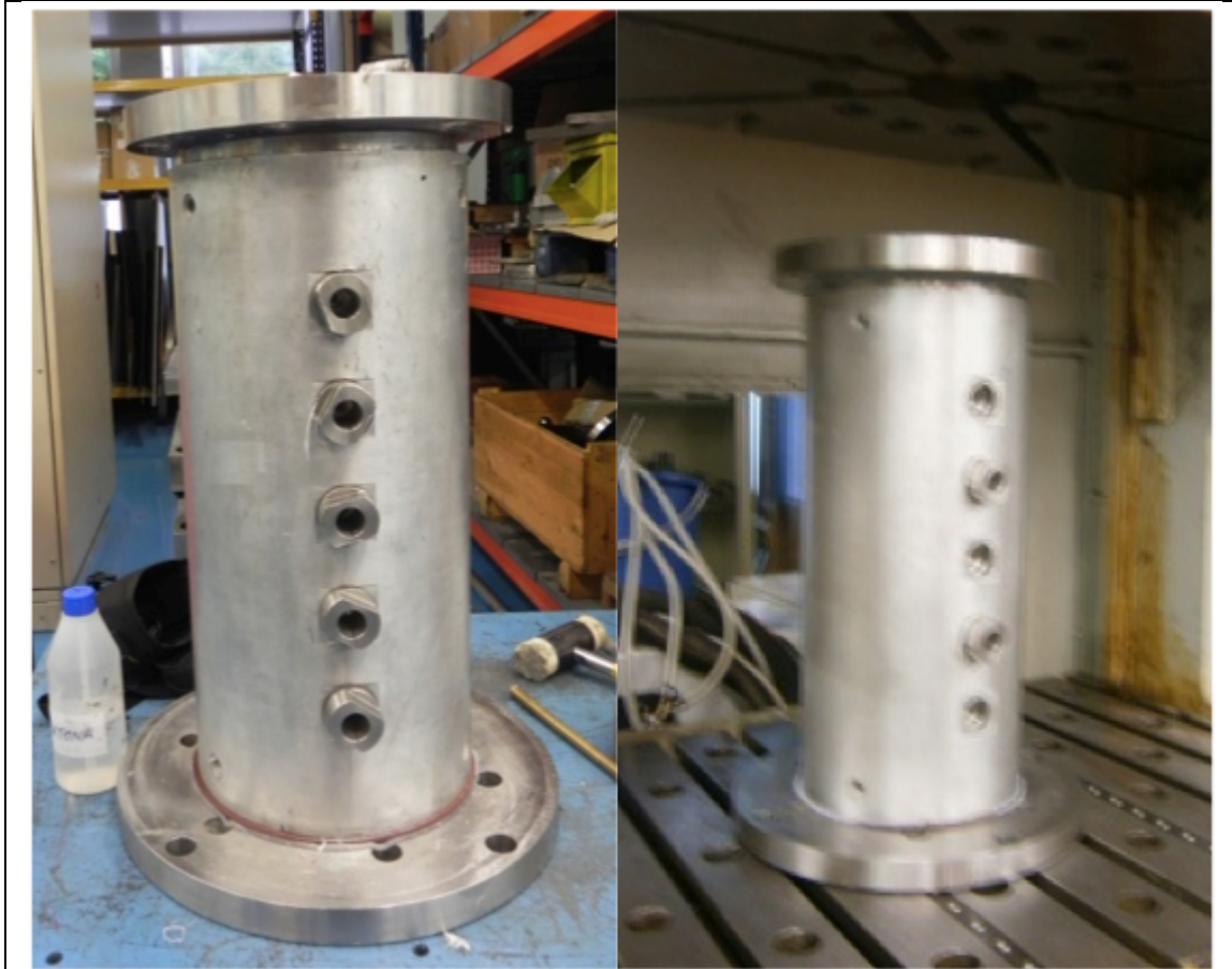
Conjunto de cilindros de la columna y su apriete en la prensa
