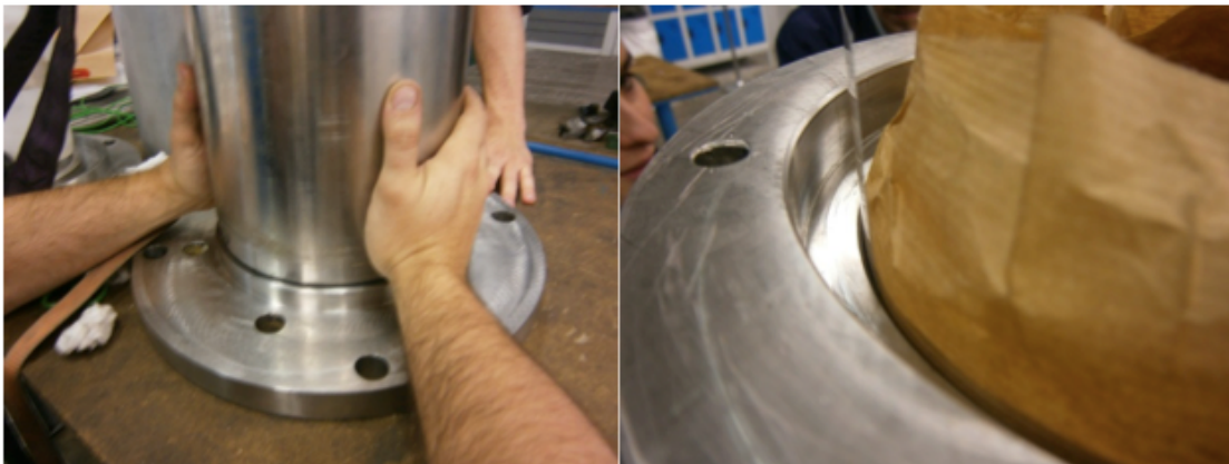
Posición del tubo externo sobre la tapa inferior y verificación del correcto espacio del GAP entre el tubo interno y externo
