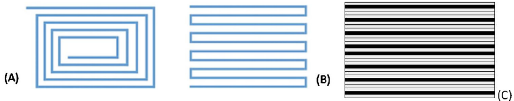
Figura 4. a) Patrón de impresión concéntrico, b) patrón isotrópico y c) secuencia de apilamiento de capas [Dickson2017].
