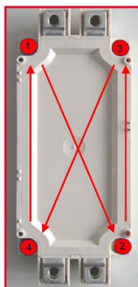
Irudia 110. Infineonek gomendatutako torlojuak lotzeko sekuentzia.
