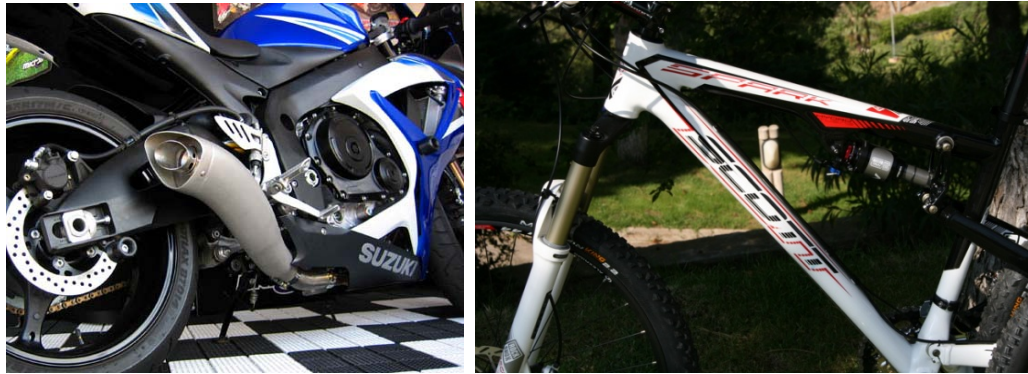
Figura 3.15: a) Tubo de escape hidroconformado desarrollado (Micron, 2008) y b) cuadro de bicicleta hidroconformado (Velonews, 2009)
