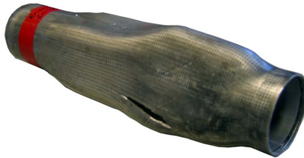
Figura 6.8: Ejemplo de rotura por alimentación insuficiente de material
