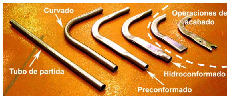
Figura 3.6: Etapas del proceso de fabricación de un pedal de freno por hidroconformado de tubo (Aginagalde, et al., 2006)
