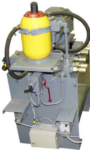
Figura 5.14: Grupo hidráulico de caudal variable.
