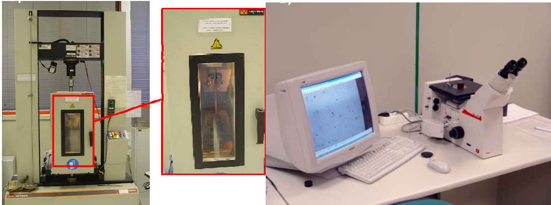
Figura 2.4: a) Máquina de tracción uniaxial INSTRON-4206 y b) Microscopio LEICA DM IRM
