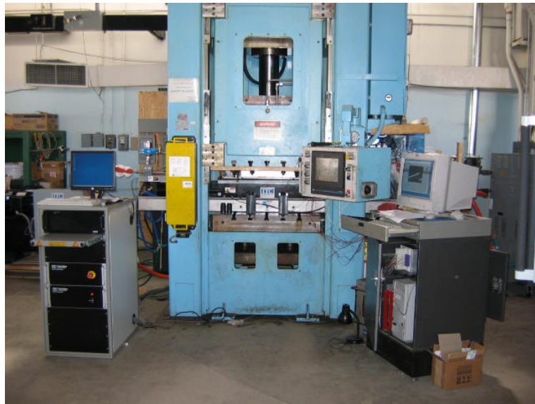
Figura 5.9: Instalación piloto de WTHF sumergido desarrollado en ERC/NSM Ohio State University
