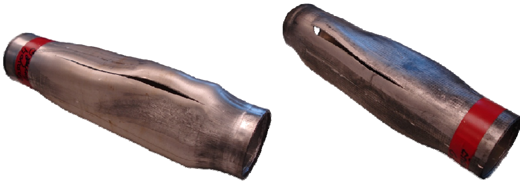
Figura 6.6: Ejemplos de rotura por unión de soldada
