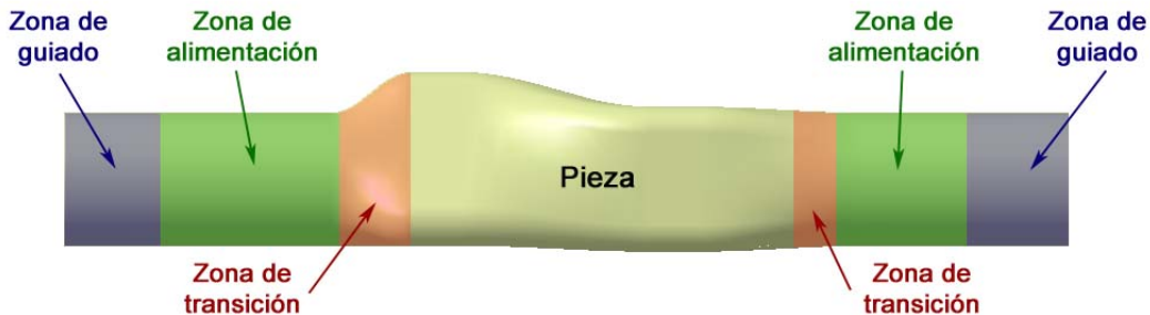
Figura 4.12: Esquema del diseño de las zona de guiado, las zona de alimentación y las zonas de transición.
