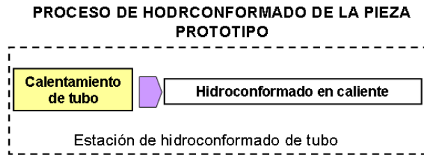
Figura 3.26: Esquema las etapas del proceso de hidroconformado de la pieza prototipo.
