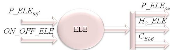
**Figura 6.5.** Entradas/salidas agente activo Electrolizador + inversor.
