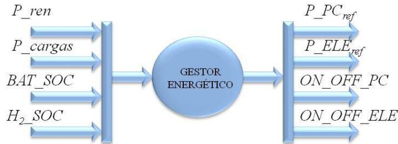
Figura 6.13. Entradas/ salidas agente de control Gestor Energético.
