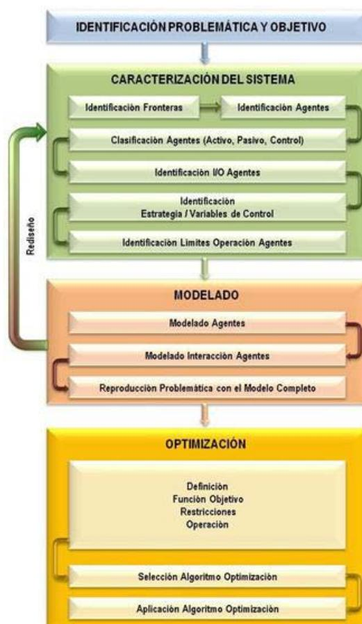
Figura 3.12. Metodología de aplicación de las herramientas de optimización.
