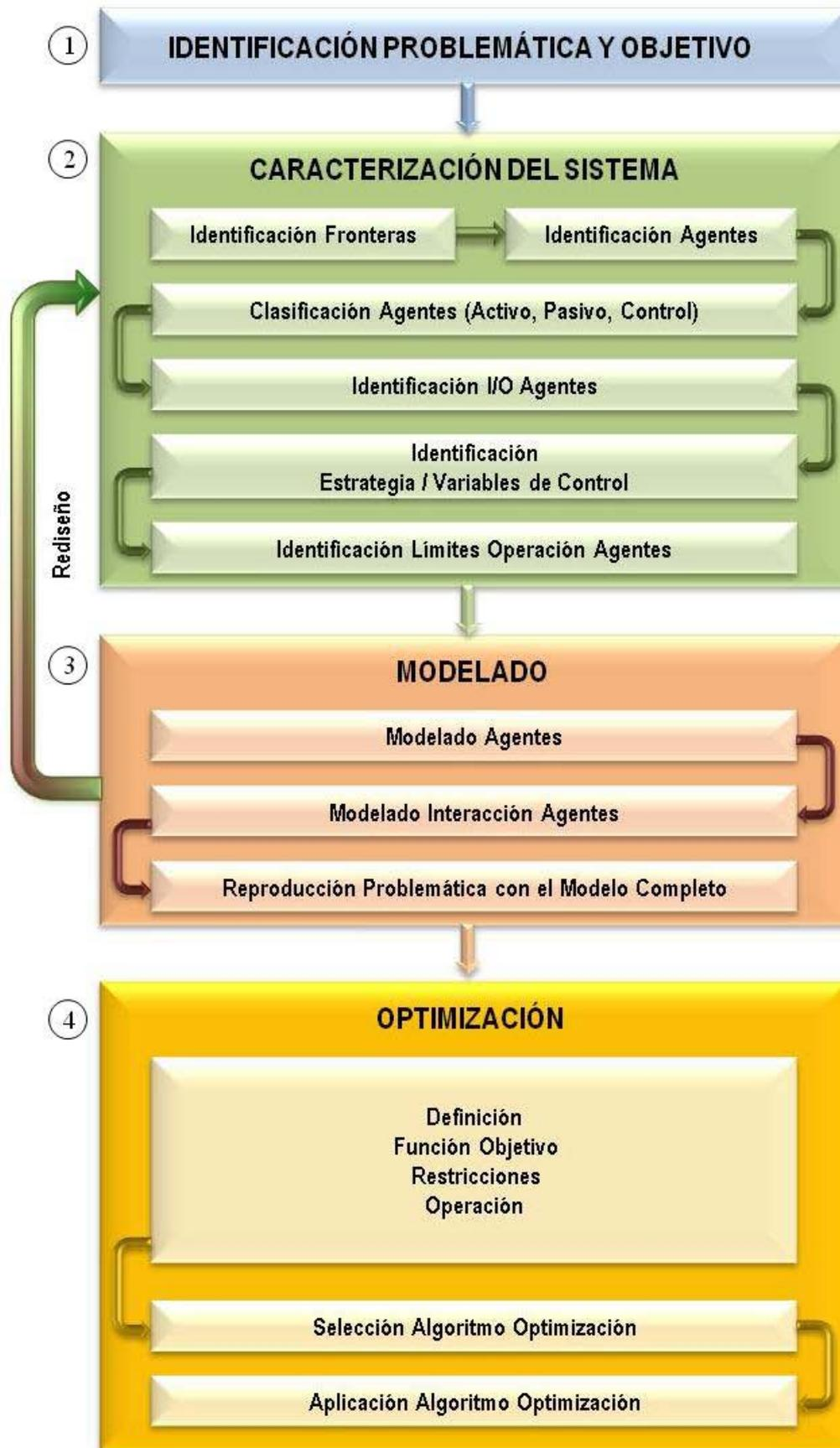
Figura 3.2. Secuencia de la metodología propuesta de aplicación de las herramientas de optimización.
