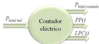
**Figura 5.7.** Entradas/salidas agente pasivo contador eléctrico.
