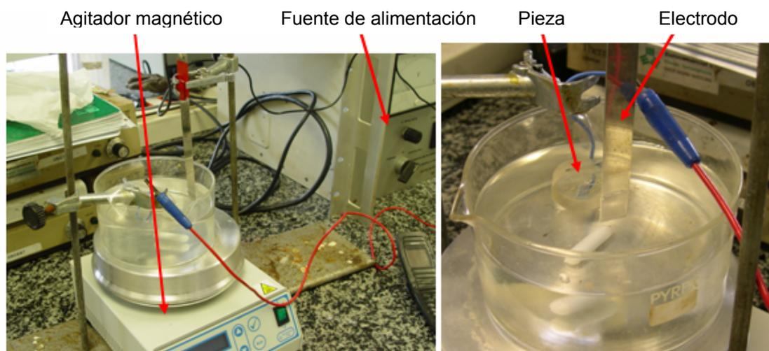
**Figura 3.23:** Configuración empleada para el ataque Barker's.
