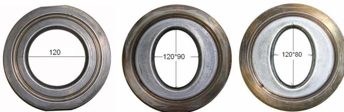
**Figura 5.25.** Geometrías de las matrices seleccionadas para la obtención de diagramas FLD.
