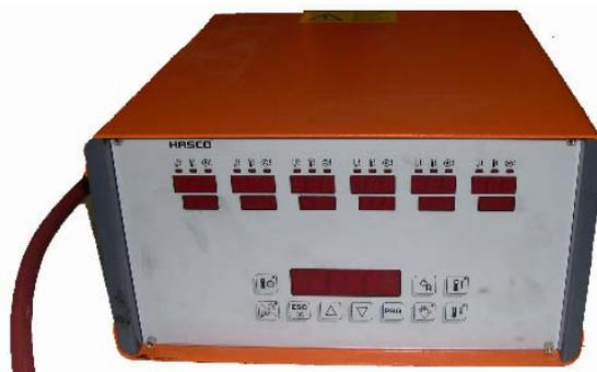
Figura 4.11: Controlador de temperatura de la marca HASCO.
