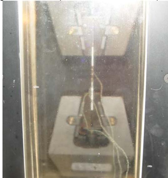
Figura I.2: Probeta dentro de la cámara climática
