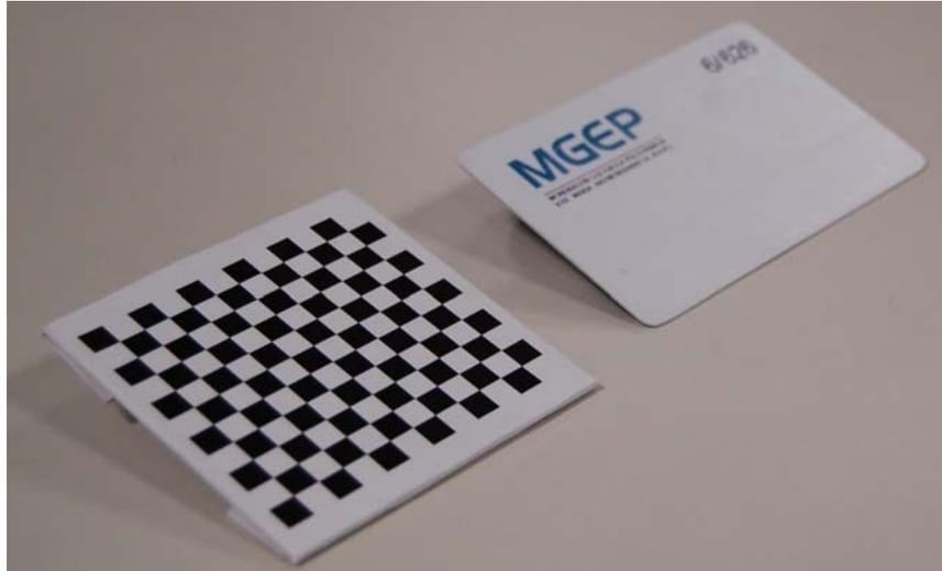
**Figura 4.17:** Patrón de calibración.
