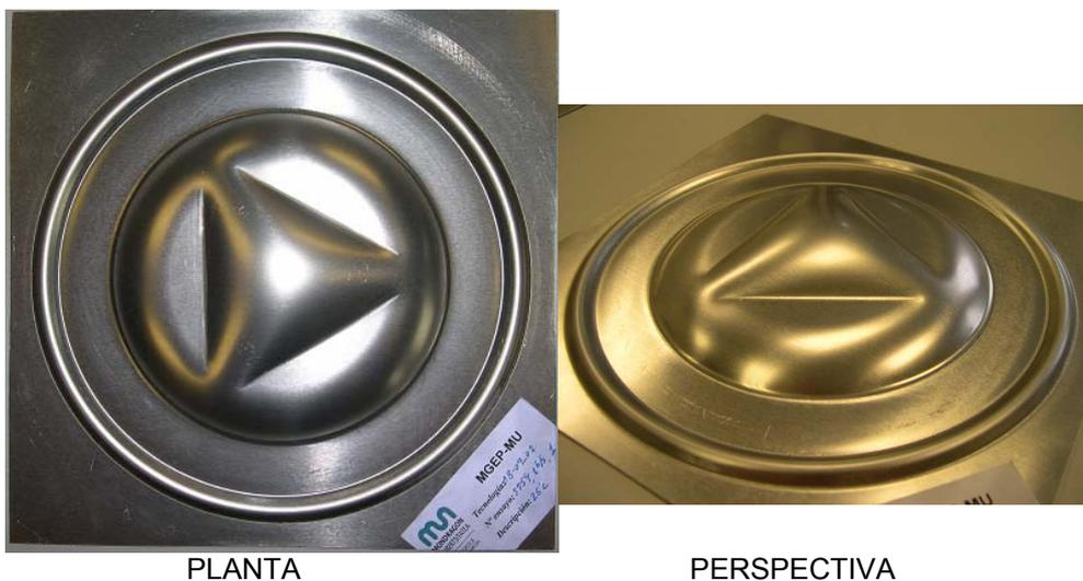
Figura 5.45. Pieza prototipo obtenida a 25 °C para la aleación AA5754H111 a 4 bar/s.
