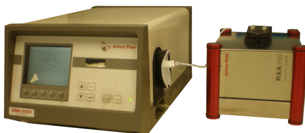
Figura 2.3: Conjunto de densímetro Anton Paar DMA 5000 y refractómetro Anton Paar RXA 156 en su configuración para la realización de medidas simultáneas de la densidad e índice de refracción.
