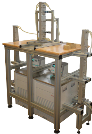
Figura 2.10: Instalación termogravitacional plana.
