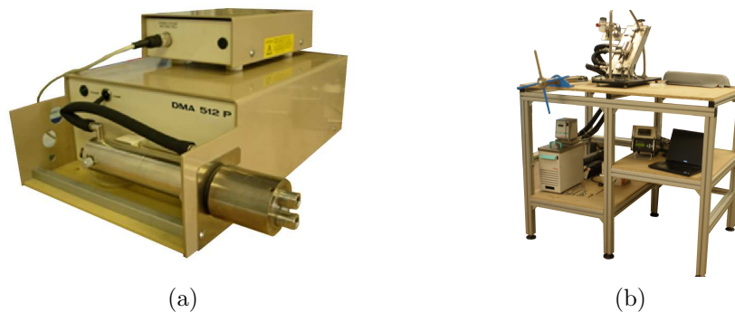
Figura 3.17: Dispositivos para el estudio de las propiedades de transporte a altas presiones (a) célula Anton Paar DMA512P y (b) viscosímetro Viscolab PVT High Pressure Regulating Bath System.
