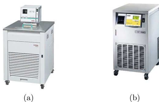
Figura 2.11: Baño termostáticos (a) Julabo y (b) Lauda utilizados para generar el gradiente de temperatura en las columnas termogravitacionales.
