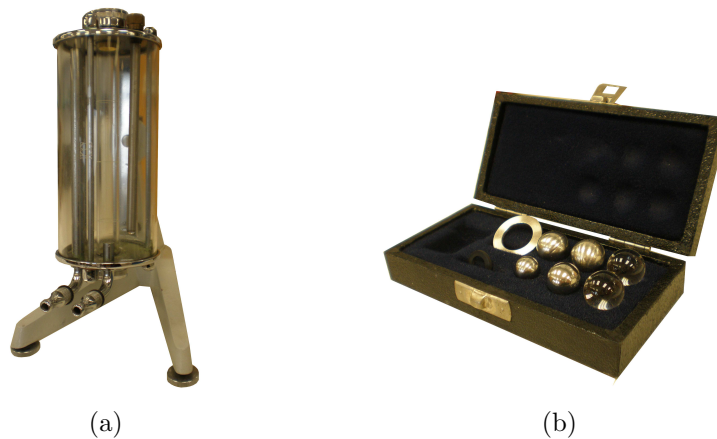
Figura 2.7: Viscosímetro HAAKE de caída de bola. (a) Imagen del dispositivo y (b) diferentes bolas disponibles para el viscosímetro.
