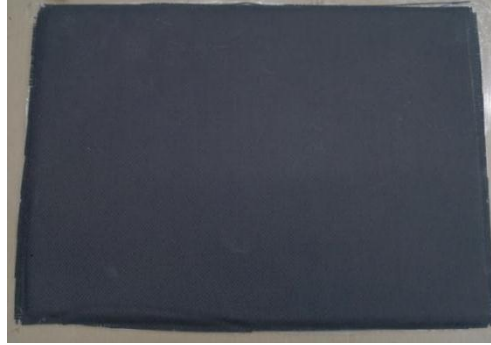
Figura 4.11 Placa obtenida a través del proceso de infusión.
