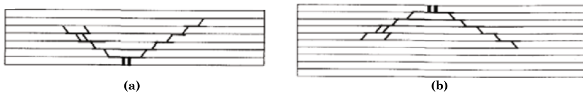
Figura 2.5 Descripción de la evolución del daño para laminados multidireccionales: (a) placas delgadas y (b) placas gruesas según Abrate (Abrate 2005).
