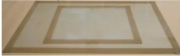
Figura 4.5 Vidrio templado sobre el que se realiza la infusión (perímetro exterior) y molde inferior delimitado por cinta adhesiva (perímetro interior).
