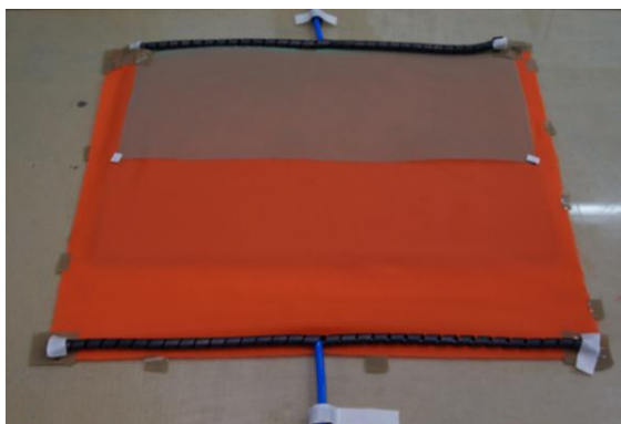
Figura 4.8 Colocación de los conductos de entrada (superior) y salida (inferior) de la resina.
