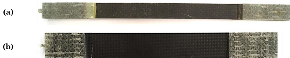
Figura 4.13 Probetas con talones obtenidas por corte por chorro de agua para (a) ensayos de tracción y (b) ensayos de cizalladura.
