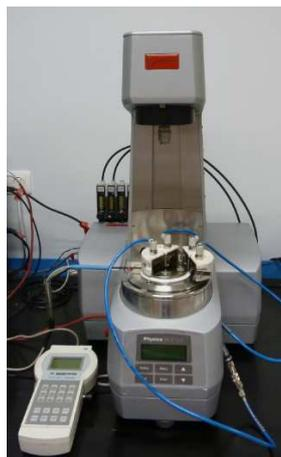
**Figura 3.4** Reómetro rotacional MCR-501 (Anton Paar) equipado con célula magnetorreológica MRD-70/1T.
