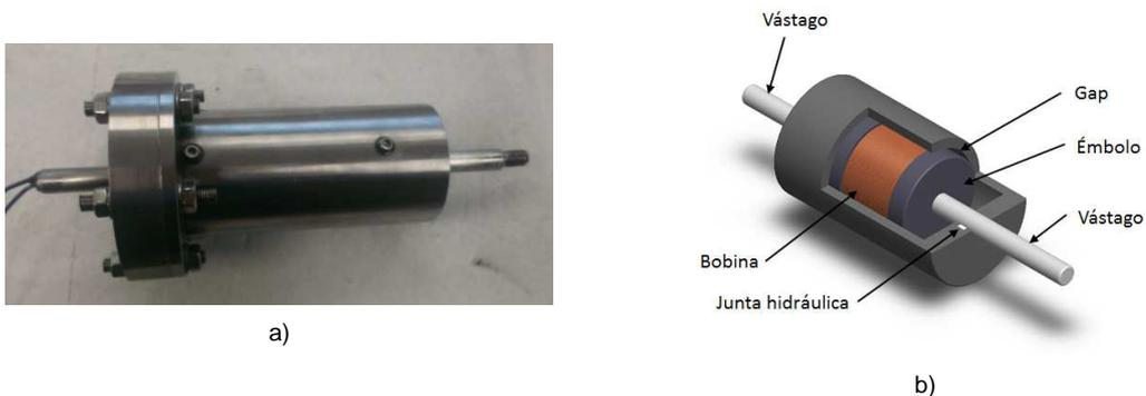
**Figura 4.16** Prototipo de amortiguador MR en modo válvula; a) Foto; b) Esquema.
