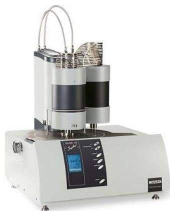
Figura 3-2. Equipo utilizado para obtener las muestras DSC.
