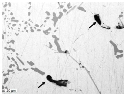
Figura 3-12. Fases fundidas en la aleación E1 tras DS-530.
