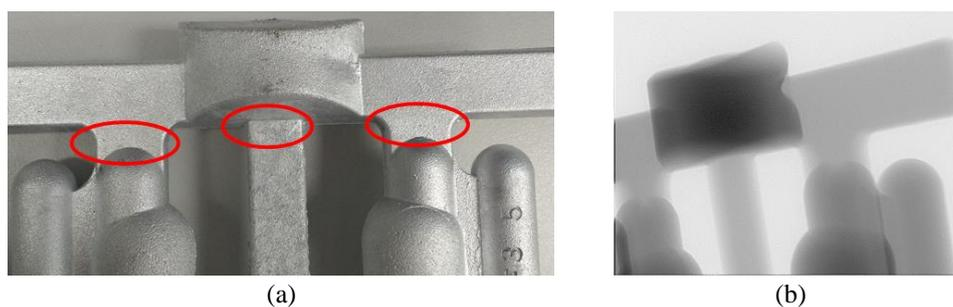
Figura 3-21. a) Imagen de la zona en forma de "T" del molde probetero donde no se observan grietas. b) Imagen de la misma zona en rayos X.
