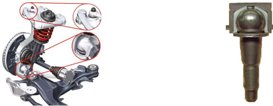
(a) Diferentes rótulas en la suspensión delantera de un automóvil [23]. (b) Sección de una rótula de una bieleta estabilizadora de un automóvil [24].
