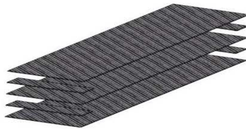
Figura 67: Configuración de la preforma utilizada para la fabricación de la pieza [81].
