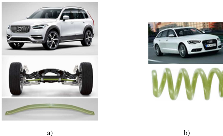
Figura 3: Aplicaciones de composites en elementos de suspensión de coche comerciales: a) Eje trasero del Volvo XC 90 y b) muelles helicoidales del Audi A6 Avant.
