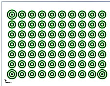
**Figura 3.7:** Detección de los puntos de control en un patrón con círculos concéntricos.
