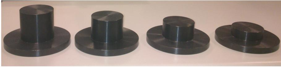
**Figura 5.6:** Discos con diferentes alturas utilizados para la comprobación de la precisión en altura.
