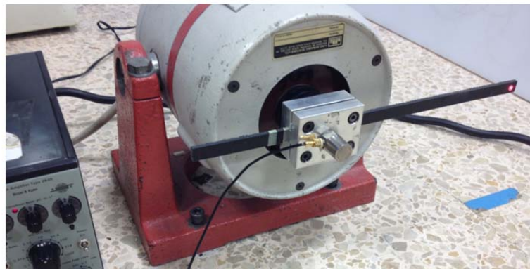
Figura 4.6 Cadena de medida y el equipo empleado en la caracterización por la técnica de vibraciones forzadas con resonancia
