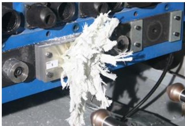
**Figura 75:** Aspecto de la estructura después del ensayo dinámico de impacto.
