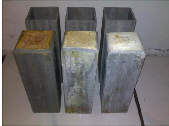
**Figura 49:** Estructuras de impacto cuadradas de vidrio/poliéster fabricadas por pultrusión [115].
