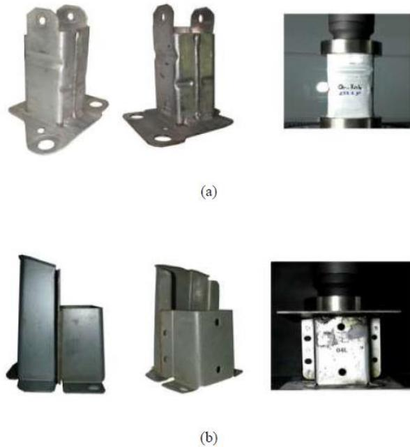
**Figura 3:** a) Estructura de impacto en aluminio de un Renault Megane. b) Estructura de impacto en acero de un Honda Accord [3].
