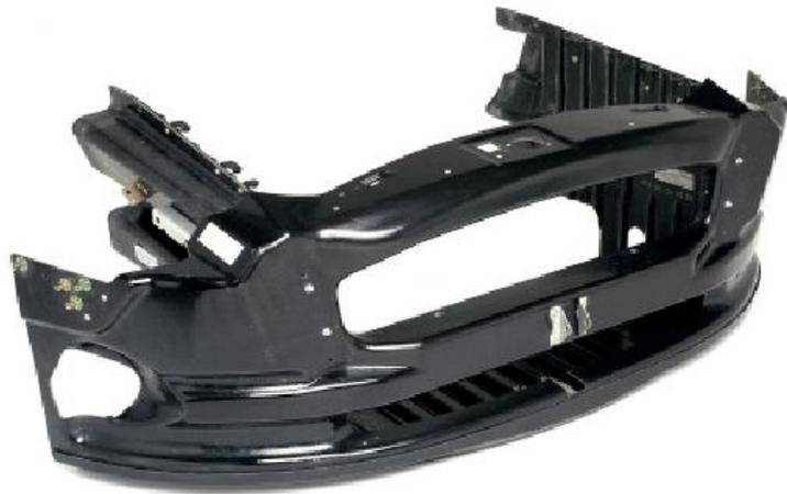
**Figura 5:** Estructura de impacto de un vehículo deportivo fabricado en CFRP [14].
