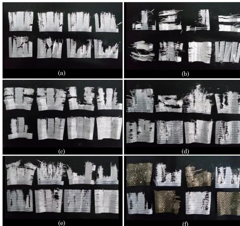
**Figura 56:** Aspecto de las fibras después de los ensayos: (a) [U]<sub>s</sub>. (b) [U/T]<sub>4s</sub>. (c) [Bi]<sub>s</sub>. (d) [U/Bi]<sub>4s</sub>. (e) [BI/U]<sub>4s</sub>. (f) [Bas/U]<sub>4s</sub>.
