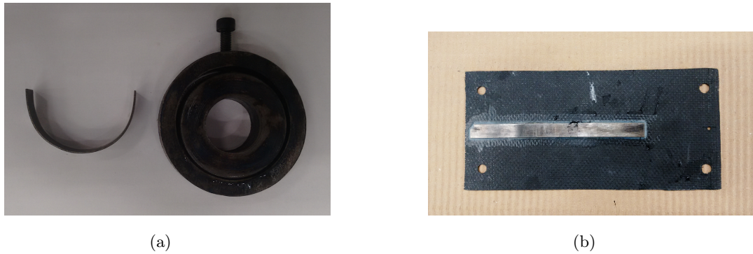
Figura 8.9: a) SMA deformado y molde. b) Viga de SMA adherida a la placa de compuesto.
