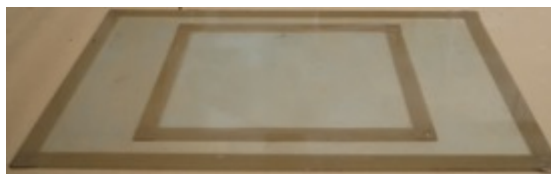
Figura 8.2. Vidrio templado sobre el que se realiza la infusión (perímetro exterior) y molde inferior delimitado por cinta adhesiva (perímetro interior).
