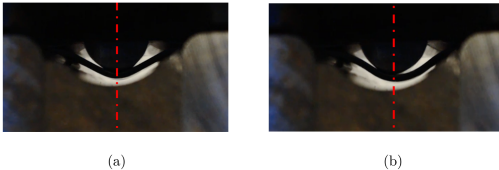
Fig. 47 Fotos de la geometría que adopta la chapa en el freno en la situación de (a) enclavamiento y (b) tiro del material.
