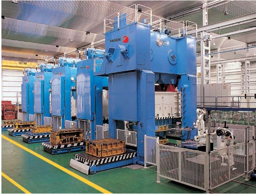
Fig. 2 Línea de prensas en donde se puede observar el tamaño superior de la prensa de cabecera encargada de realizar la embutición profunda principal del proceso (Fagor Arrasate 2013).
