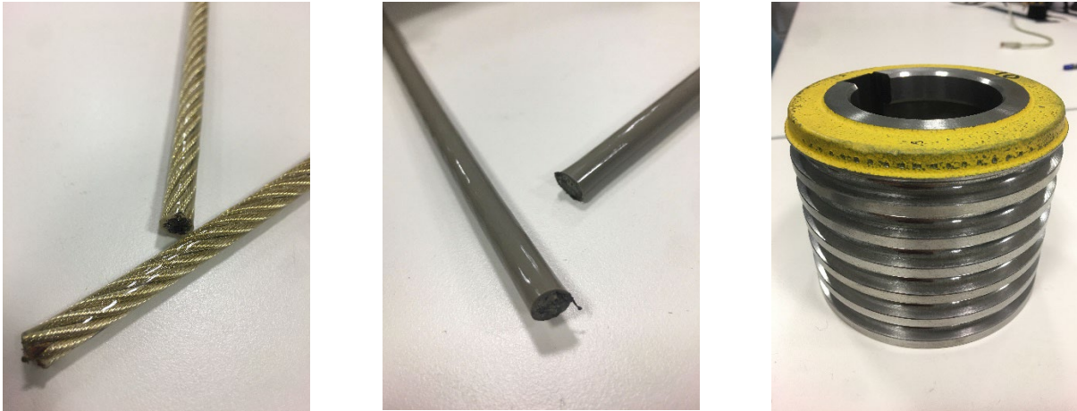
2. irudia. Entseguetan erabilitako materiala: SDR kablea (ezk.), SDR E kablea (erd.) eta polea (esk.).
