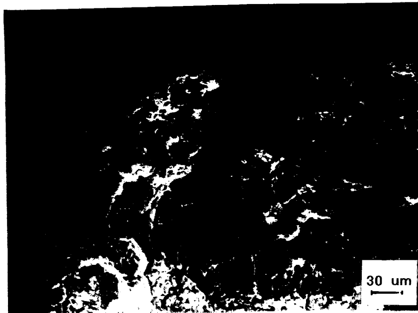
4.58. Ir.: Px30 hutsean sinterizatua + HIP eta 550°C-tan iratua. Fig. 4.58: Px30 sinterizado en vacío + HIP y revenido a 550°C.
