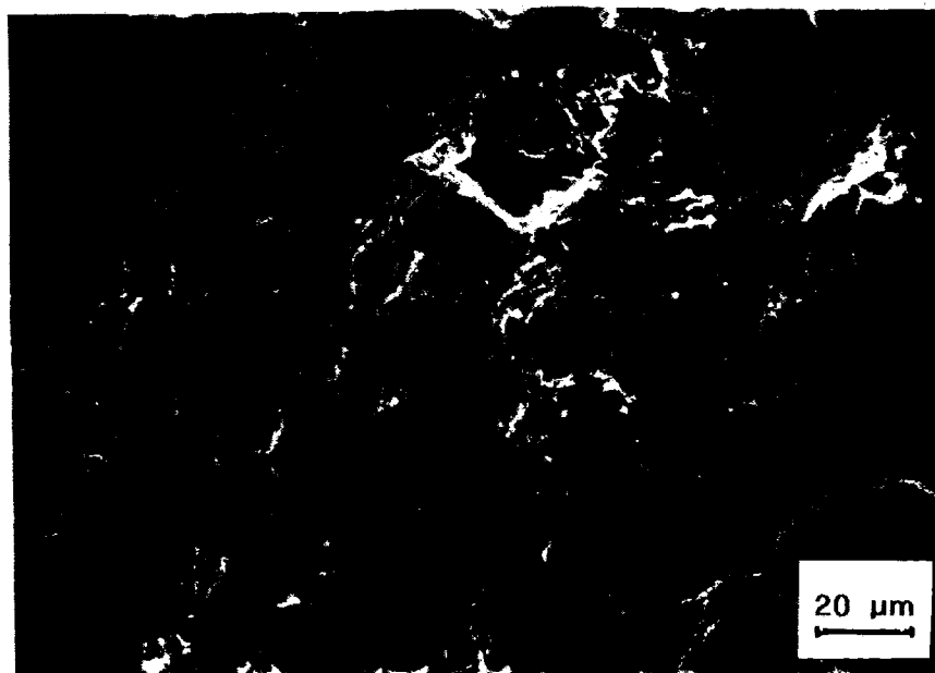
4.58. Ir.: Px30 hutsean sinterizatua + HIP eta 550°C-tan iratua. Fig. 4.58: Px30 sinterizado en vacío + HIP y revenido a 550°C.
