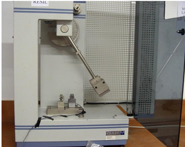
Figura 2.9: Máquina de ensayos de impacto pendular junto con el utillaje de impacto tracción instrumentado.
