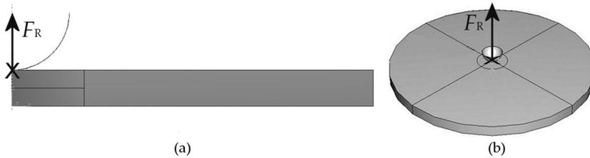
Figura 3.8: Fuerza de reacción  $F_R$  debido al contacto en el punto de referencia asociado al impactor, (a) en el modelo axisimétrico y (b) en el modelo 3D.
