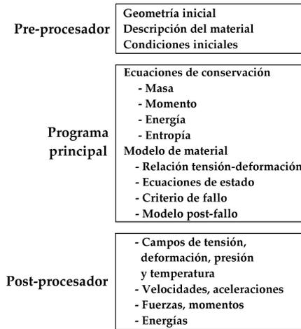
Figura 1.13: Esquema del proceso computacional del método numérico.
