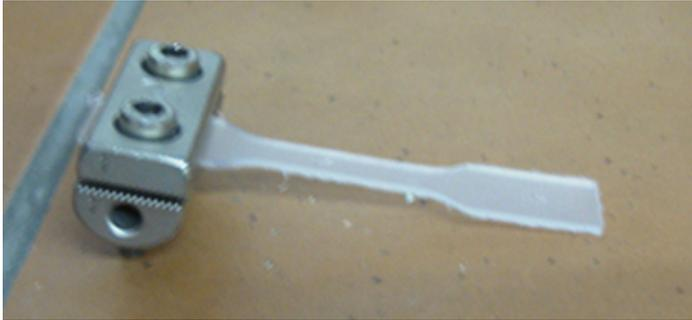
Figura 2.10: Probeta amarrada por uno de sus extremos a la mordaza móvil del utillaje de impacto-tracción.
