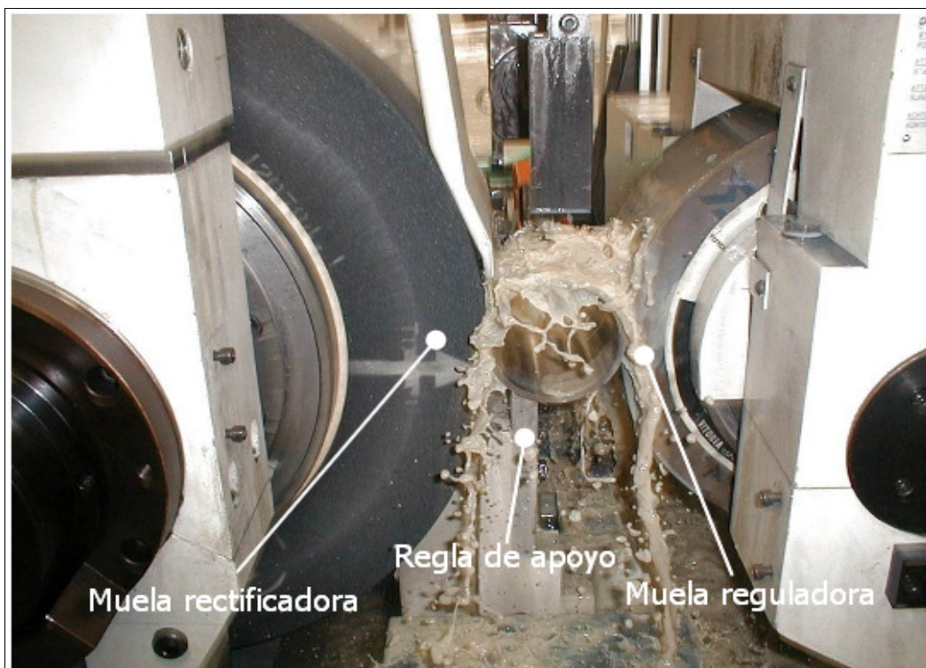
Figura 1.2: Configuración de trabajo de un proceso de rectificados in centros. Camisa motor siendo rectificada (Estarta Rectificadora S.Coop).
