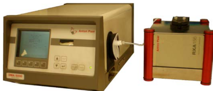
Figura 3.2. Densímetro ANTON PAAR DMA 500 y refractómetro ANTON PAAR RXA 156
