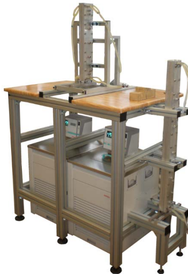
Figura 2.2. Instalación termogravitacional formada por las dos columnas planas de L_z = 500 mm y de L_x = 980 mm
