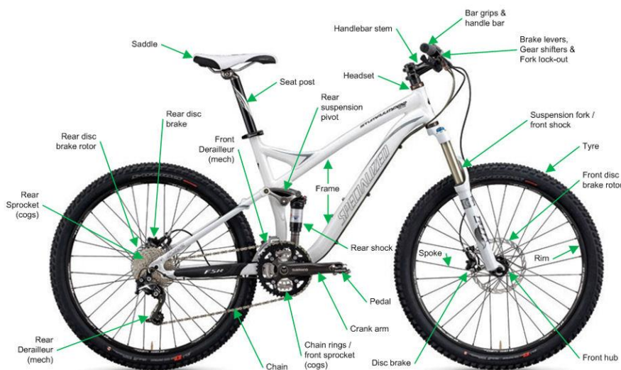
Ilustración 18. Componentes de una bicicleta de montaña de doble suspensión.
