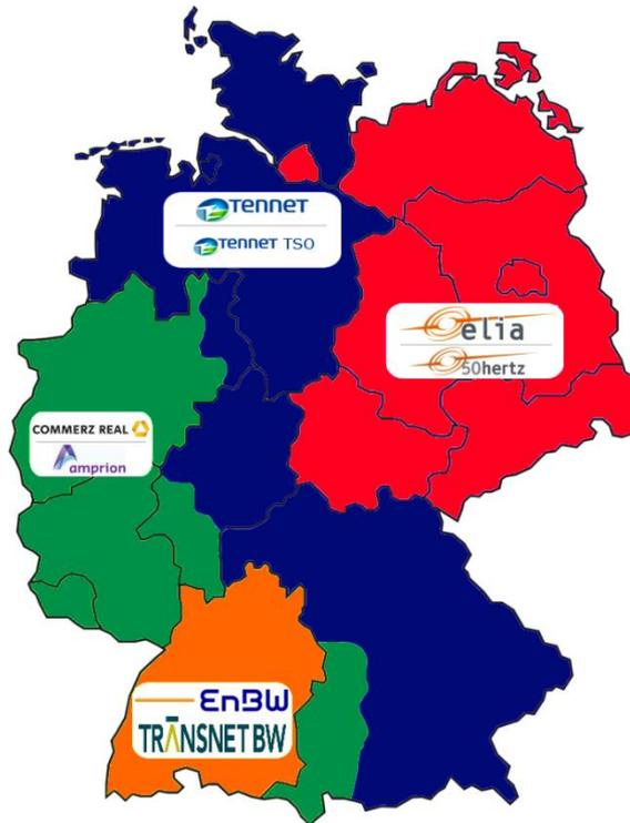
Figura 4.9. Las cuatro regiones eléctricas alemanas y sus correspondientes operadores. Fuente: Wikipedia
