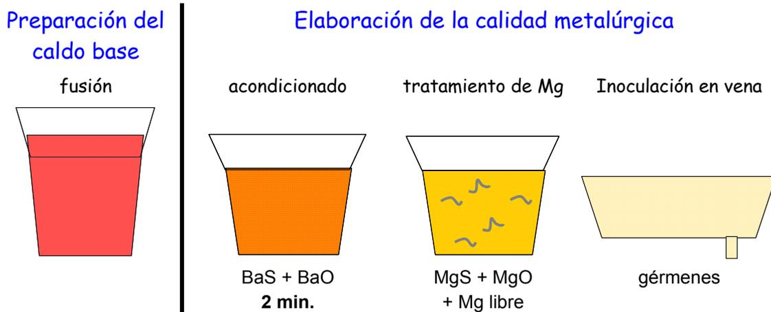
**Figura 60:** Esquema de elaboración de la nueva metodología de elaboración del caldo [Ber06]. Mediante la introducción de la etapa de acondicionado se separa el proceso en dos fases. La primera fase comprende la fusión de la carga metálica para obtener el caldo base con la composición química deseada. En la segunda fase se elabora la calidad metalúrgica y está formada por las etapas de acondicionado, tratamiento de Mg e inoculación final.
