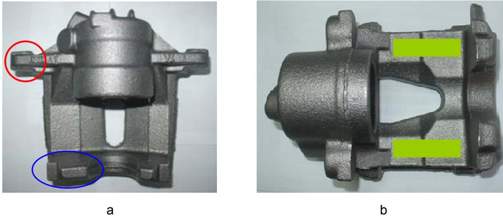
**Figura 59:** Emplazamiento de las probetas sobre los calipers. a) Probetas para el control metalográfico empleadas habitualmente en VLU, en rojo se indica la zona de extracción de la probeta denominada *oreja* y en azul para la probeta designada como *pata*. b) En verde se indica la zona de extracción de las probetas para los ensayos mecánicos, además de la probeta denominada *lomo* para el análisis metalográfico.
