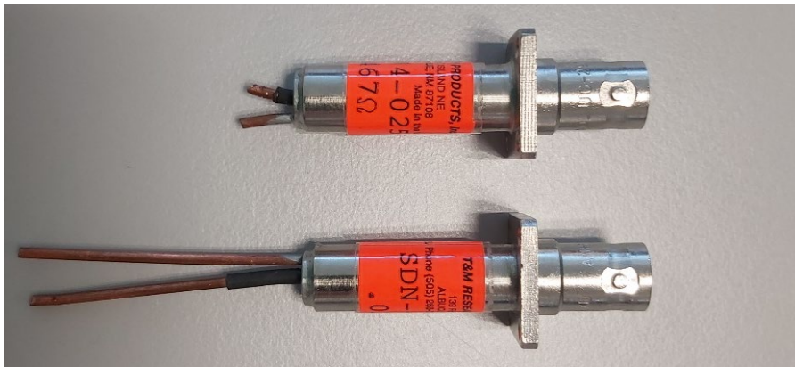
Figura 4.2 – Coaxial shunt original (debajo) vs. coaxial shunt modificada (arriba).
