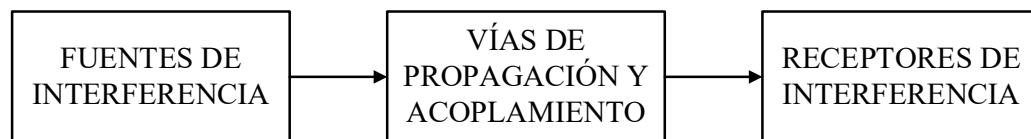
Figura 1.3 – Esquema general de generación y propagación de EMI.
