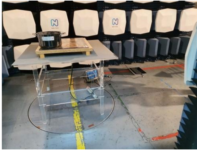
Figura 4.32 – Medición de encimera de inducción en cámara semianecoica con equipos de Mondragon Unibertsitatea y sonda de corriente.
