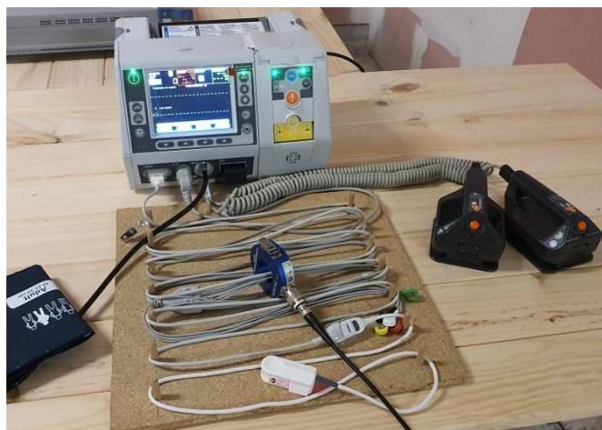
Figura 4.29 – Configuración de la medición de corriente en desfibrilador.
